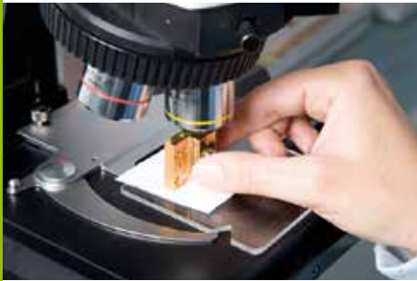
Inspección del posicionamiento de una barra láser en montura CS, montada con la técnica de “clamping” (pinzado). Monocrom
