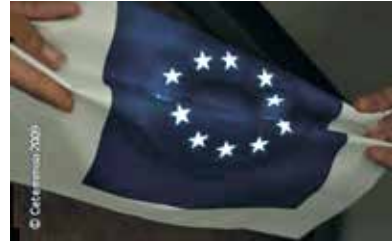
Dispositivo electroluminiscente inorgánico depositado por técnicas de impresión sobre sustrato textil.
