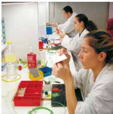
Técnicos de Fibercom realizando el proceso de conectorización de cordones fibra óptica. FIBERCOM
