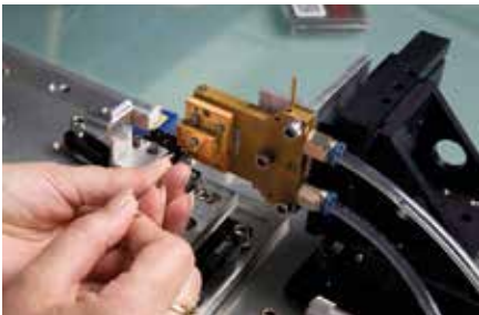
Banco de pruebas de barras láser. Monocrom
